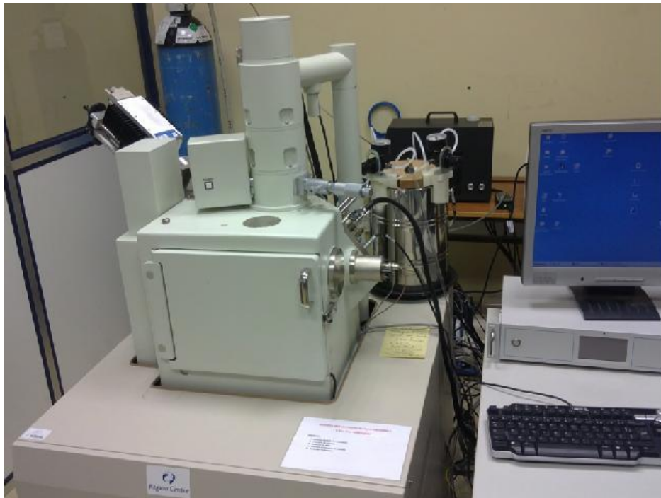
Figure II- 11: Microscopie électronique à balayage JSM-6480LV au LMR
